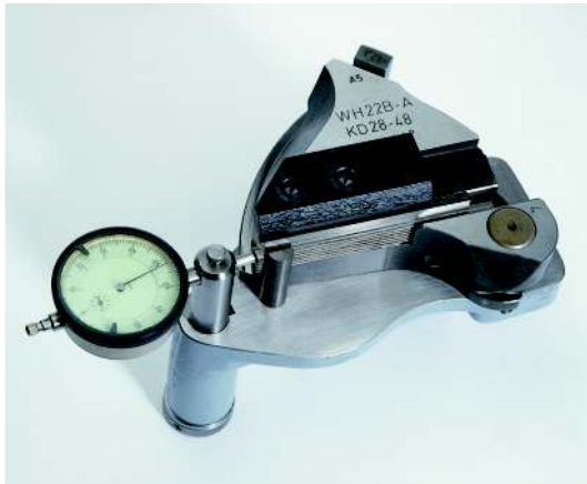
Einstellen des Strehlers im Strehlerhalter mit Hilfe der Strehler-Einstellvorrichtung
