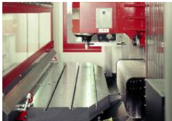
Przestrzeń obróbcza matec-30 SG
