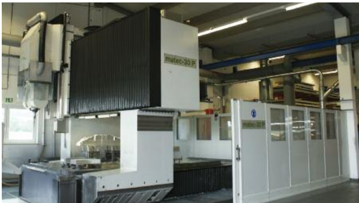
matec-30 P ma wystarczająco duże powierzchnie mocujące dla dużych i wielu mniejszych detali
