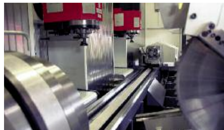
2 przesuwne kolumny, stół obrotowy CNC i przeciwwrzeciono
