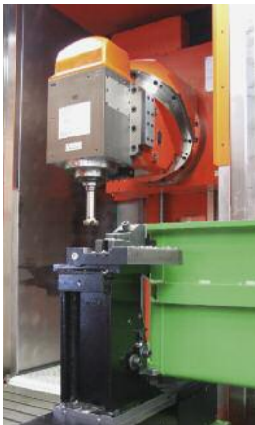
Maszyny matec-40 HVU z mocowaniem narzędzi SK50, względnie HSK-A 100, to idealne rozwiązanie dla obróbki ciężkiej
