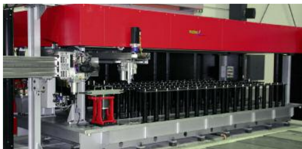
matec-50 P z płaskim magazynem narzędzi HSK-A 100 (wersja 200-pozycyjna)
