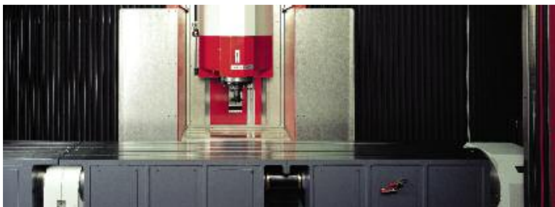
matec-30 L z podwójnym stołem uchylnym – możliwe uchylenie stołów oddzielne lub symultaniczne
