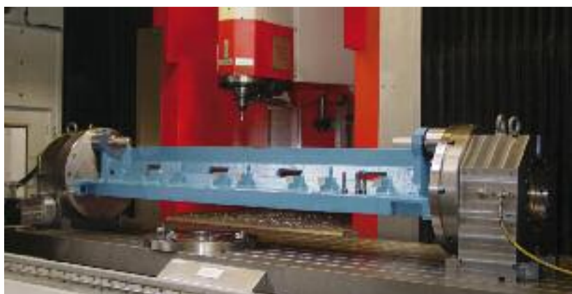
matec-30 L ze stołem obrotowym i przeciwwrzecionem
