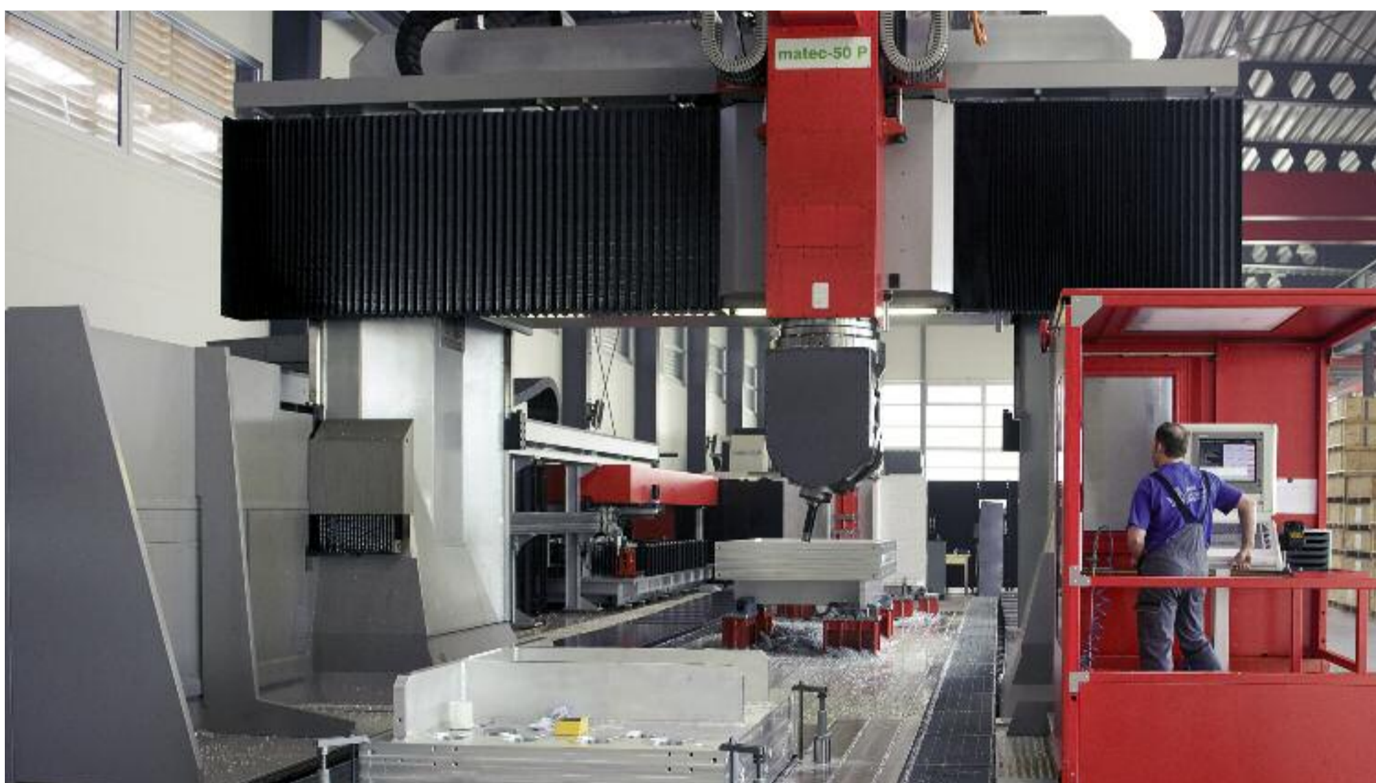
Wykonana dla klienta matec-50 P z 2-osiołą głowicą frezarską CNC, jeżdżącym pulpitem obsługowym, X=16 000 mm, Y=5 000 mm, Z=1 500 mm, W=800 mm
