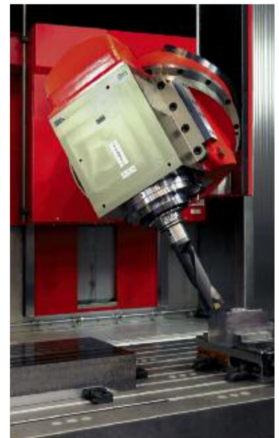
Maszyny matec-40 HVU z mocowaniem narzędzi SK50, względnie HSK-A 100, to idealne rozwiązanie dla obróbki ciężkiej
