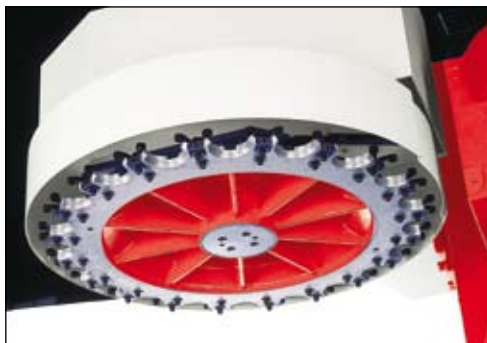
Werkzeugwechselkarussell Carousel type tool changer
