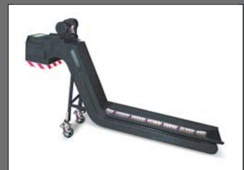
Späneförderer Typ: Gliederbandförderer Chip conveyor type: belt conveyor
