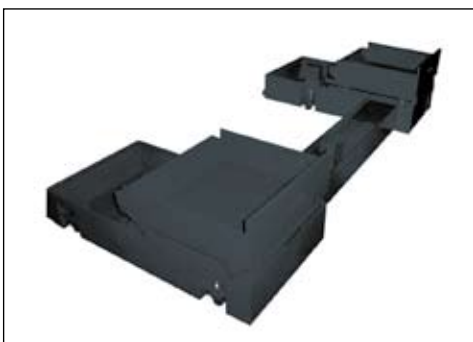
Spänekasten (Spänewanne) Chip disposal
