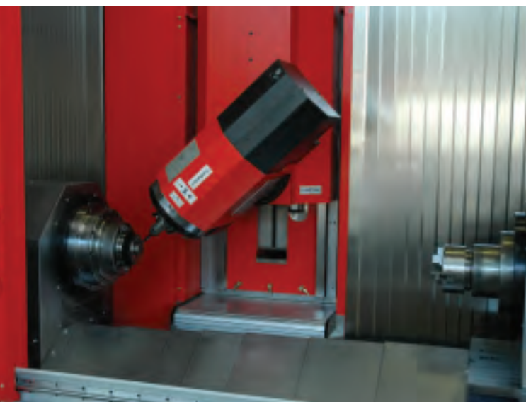
Werkstückbearbeitung an der Hauptspindel
