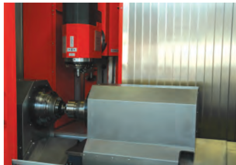
Übergabe des Werkstücks in die Gegenspindel
