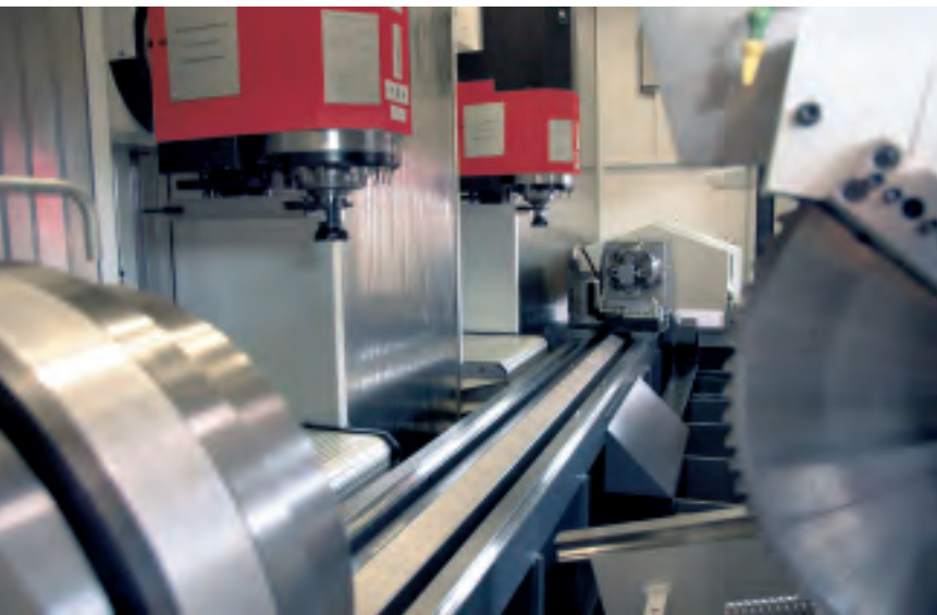
Arbeitsraum mit 2 Fahrständen, Gegenspindel bzw. CNC-Rundtisch und Sägeeinrichtung
