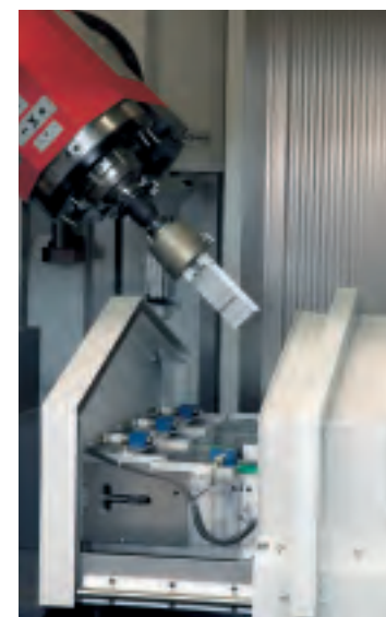
NC-Greifer legt Werkstück ab
