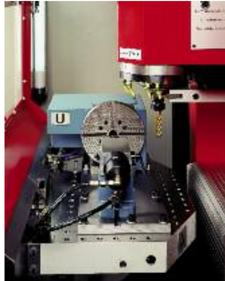
Arbeitsraum mit aufgebautem CNC-Rundtisch und Reitstock
