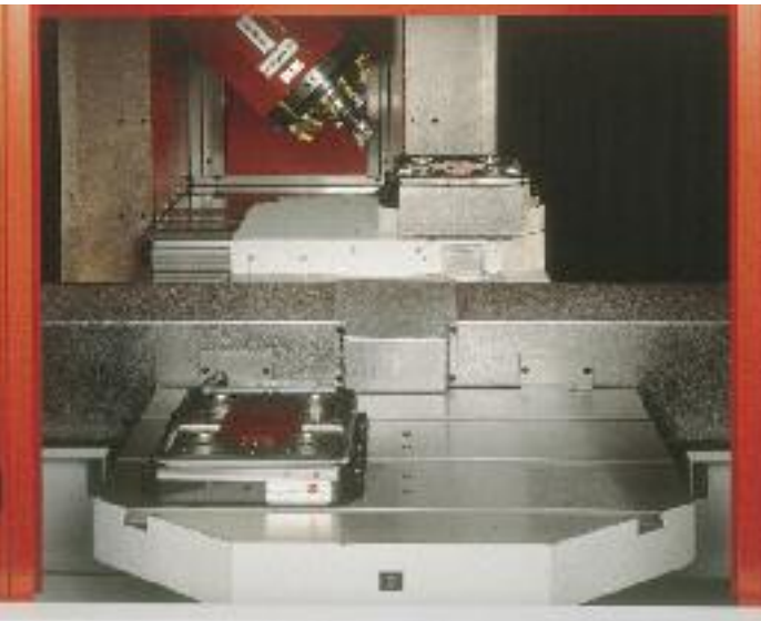
Arbeitsraum matec-30 SHV Platz 1: CNC-Rundtisch mit EROWA Palettiersystem Platz 2: stationäres EROWA Palettiersystem
