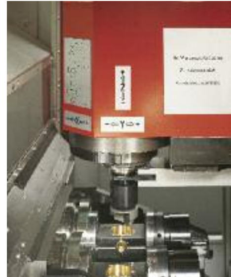
Arbeitsraum mit 2 CNC-Rundtischen, Spannvorrichtung und Bearbeitungswerkzeug
