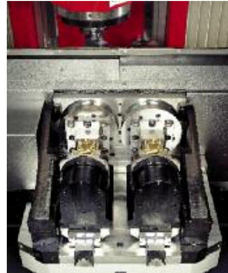
Beladestation mit 2 CNC-Rundtischen und Spannvorrichtung
